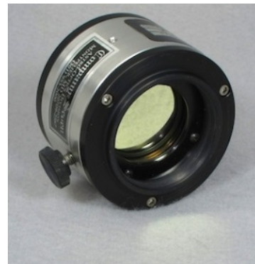
Рис. 12. Na-фильтр DayStar серии T-Scanner с полосой 0.50 Å. У фильтра видна рукоятка управления наклоном, отсутствует терморегулятор. Цветной рисунок доступен в электронной версии статьи
