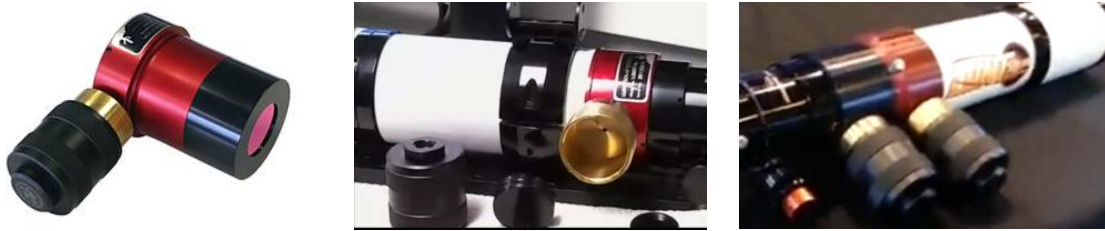
Рис. 9. Эталон с воздушным цилиндром (слева); эталон на телескопе с разобранным цилиндром: поршень и привод рядом с открытым цилиндром (в центре); двойной эталон, устанавливаемый после объектива, уменьшает полуширину полосы пропускания до величины менее 0.5 \text{ \AA} ! (справа) [http://luntsolarsystems.com/shop/, http://www.youtube.com/watch?v=Hx5abAO0ctc]. Цветной рисунок доступен в электронной версии статьи
