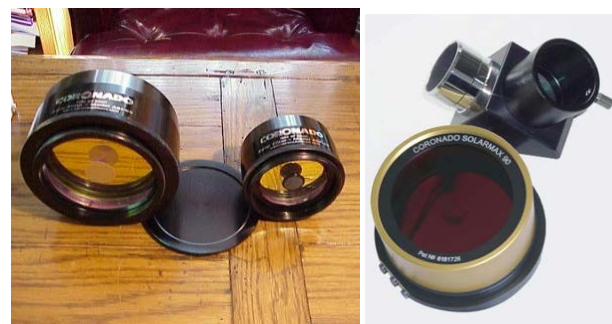
Рис. 6. Продукция компании Coronado: слева — H \alpha -фильтры диаметром 40 мм и 90 мм. Две пластинки эталона держатся вместе на оптическом контакте (зольгель-технология) независимо от оправы и креплений. Справа — эталон вместе с теплоотражающим фильтром для установки перед объективом телескопа (внизу) и окулярная часть с отрезающим фильтром (вверху) [https://www.astronomics.com/coronado-hydrogen-alpha-solar-filters_c161.aspx]. Цветной рисунок доступен в электронной версии статьи
