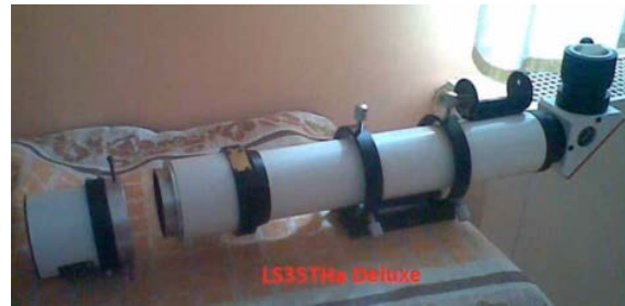
Рис. 8. Телескоп с двумя эталонами Lunt Solar Systems перед объективом [ http://luntsolarsystems.com/shop/ ]. Цветной рисунок доступен в электронной версии статьи
