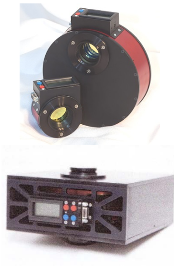
Рис. 14. Турели с фильтрами: смещение полосы пропускания производится изменением температуры фильтров (вверху), изменением температуры и наклона (внизу). Для сравнения показан фильтр серии Quantum (вверху слева). Цветной рисунок доступен в электронной версии статьи
