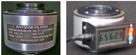
Рис. 25. H \alpha -фильтр DayStar, номер HAQPE050613. На корпусе фильтра (слева) указана номинальная длина волны 6562.8 Å, полуширина полосы 0.3 Å (в паспорте 0.38 Å). На дисплее терморегулятора фильтра (справа) отображается текущее значение \lambda_{ц} . Цветной рисунок доступен в электронной версии статьи
