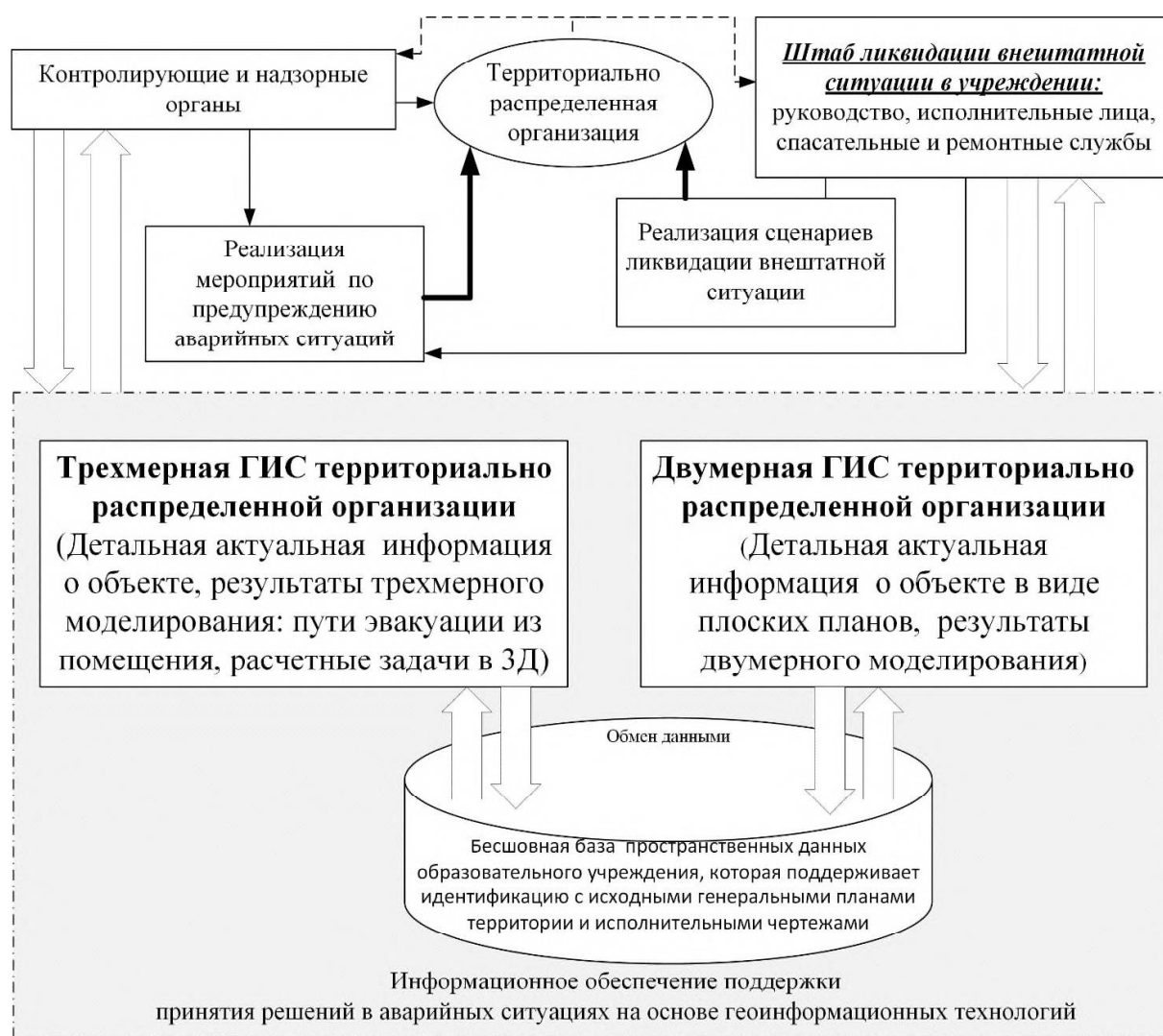
Рис. 1. Схема использования пространственных данных в аварийных ситуациях в территориально распределенная организация
