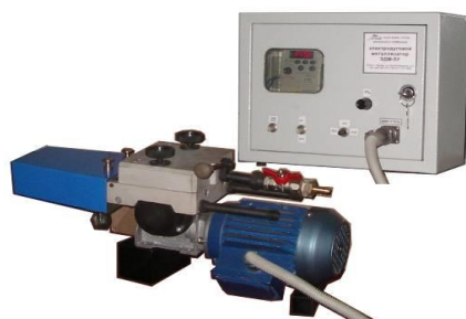
Рис. 3. Электродуговой металлизатор ЭДМ-5У
