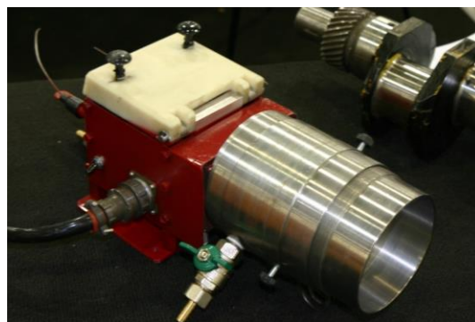
Рис. 2. Сверхзвуковой электродуговой металллизатор ЭДМ-10ШД Fig. 2. Supersonic electric arc metallizer EDM-10SHD
