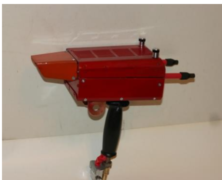
Рис. 1. Сверхзвуковой электродуговой металллизатор ЭДМ-9ШД Fig. 1. Supersonic electric arc metallizer EDM-9SHD
