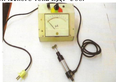
Рис. 4. Прибор для измерения давления на поверхность ПДГП-1
