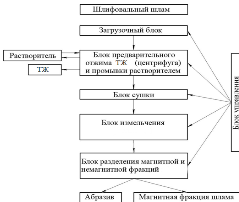
Рис. 1. Схема переработки шлама Fig. 1. Sludge processing scheme
