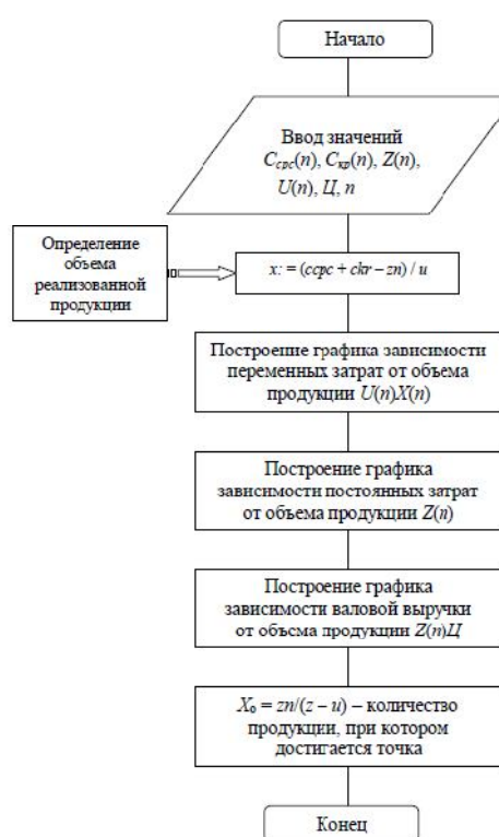
Рис. 2. Структурная схема алгоритма решения задачи определения точки безубыточности
