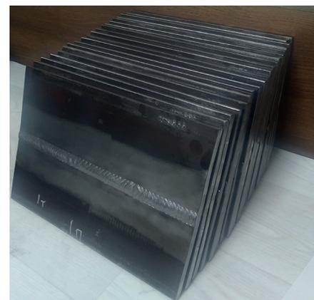
Рис. 1. Внешний вид образцов сварных соединений
