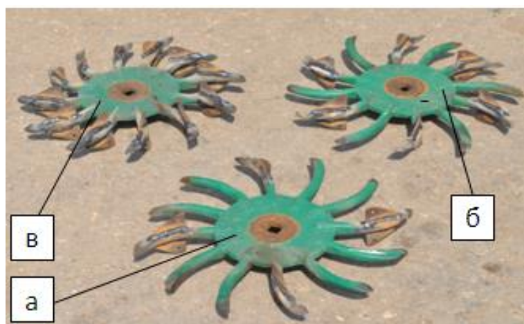
Рис. 3. Дисково-игольчатые рабочие органы первого ряда с плоскими рыхлительными элементами, установленными с интервалом в 90^\circ (а), 60^\circ (б), 30^\circ (в)
