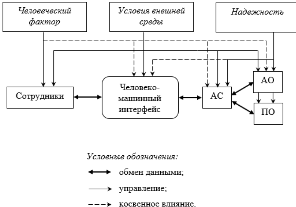
Рис. 2. Схема взаимодействия основных факторов моделирования цифрового двойника АС
