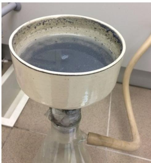
**Рис. 8.** Фильтрация взмученной суспензии на вакуум-воронке Бюхнера
