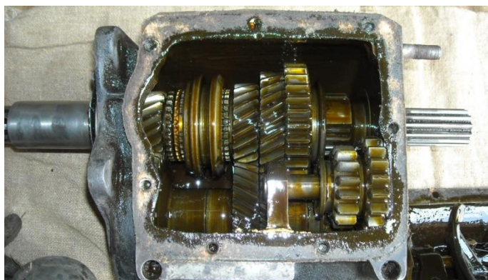
Рис. 2. Демонтированную коробку передач автобуса ПАЗ-3205 «ожидает» ремонт
