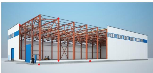
**Рис. 5.** Вертикальные несущие конструкции
