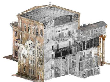
**Рис. 3.** Техническое обследование здания
