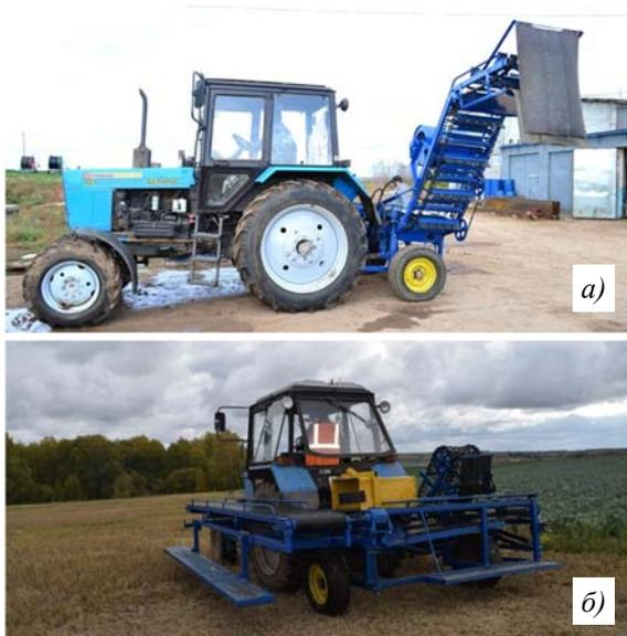
Рисунок 1 – Многовариантный капустоуборочный комбайн: а) с элеватором; б) с продольным транспортером
