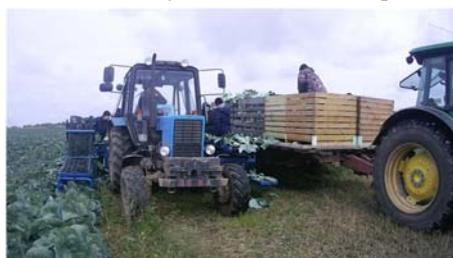
Рисунок 8 – Работа многовариантного капустоуборочного комбайна по схеме 4.
