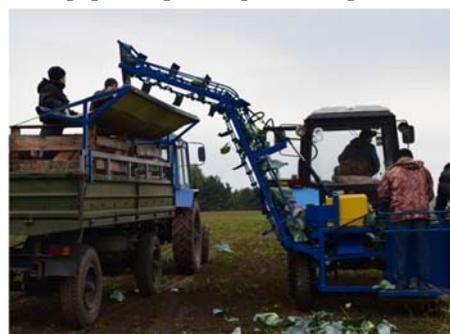
Рисунок 6 – Работа многовариантного капустоуборочного комбайна по схеме 3
