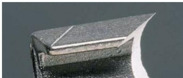
Рис. 1, а. Состояние нового режущего зуба
