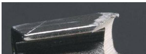
Рис. 1, в. Состояние режущего зуба после попадания абразива
