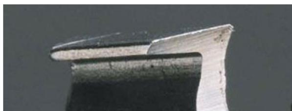
Рис. 1, б. Состояние режущего зуба после 3 часов работ
