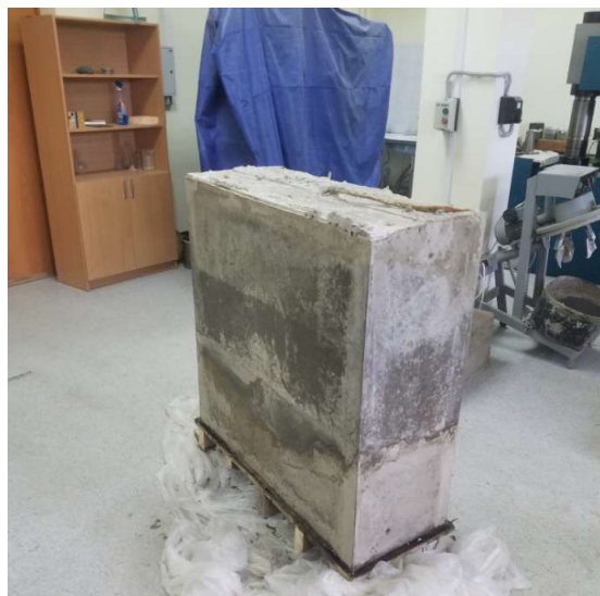
Рис. 8. Процесс изготовления макета наружной стены экспериментального здания
