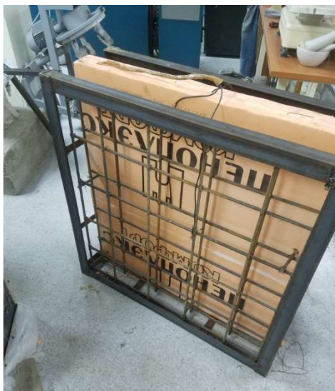
Рис. 8. Процесс изготовления макета наружной стены экспериментального здания
