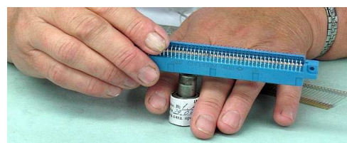
Рис. 2. Ручной процесс контроля силы расчленения контакта
