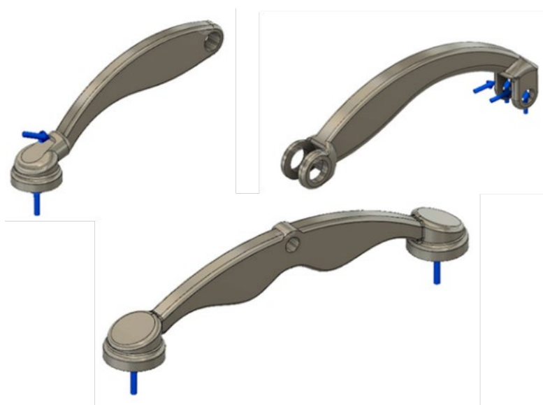
Рис. 2. Заготовки деталей подвески, подвергаемые оптимизации
