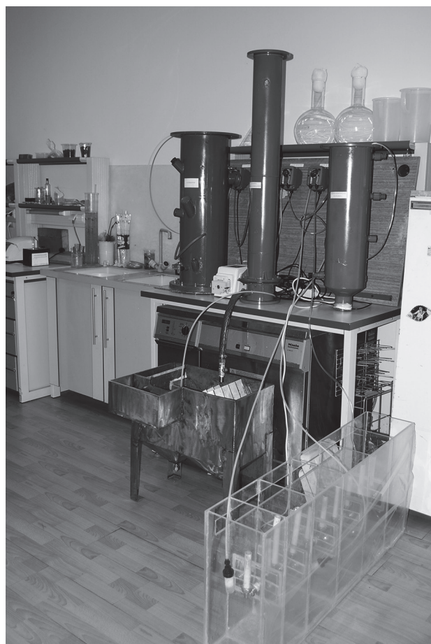
Рис. 7. Опытно-лабораторный образец установки по извлечению редких и редкоземельных металлов (скандий, иттрий, лантан)
