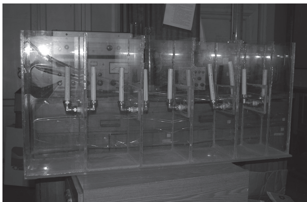
Рис. 8. Флотоотстойник с системой подачи воздуха
