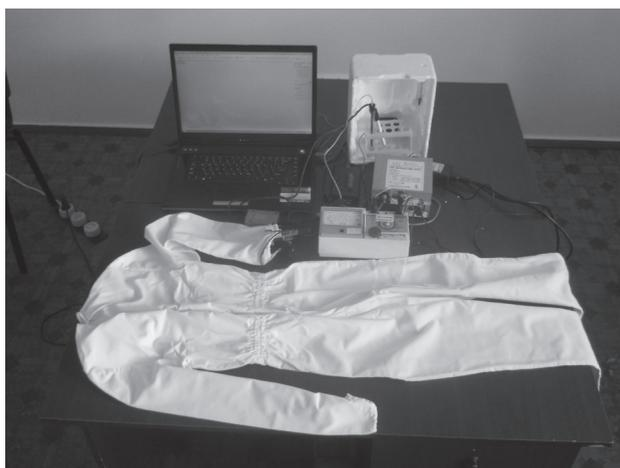
Рис. 5. Экспериментальный образец устройства для определения микробной обсемененности
