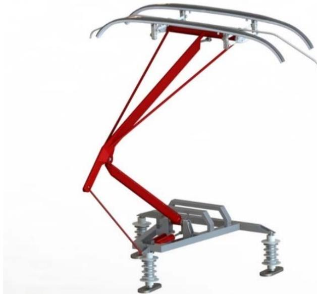
**Рис. 2.** 3D модель токоприёмника
