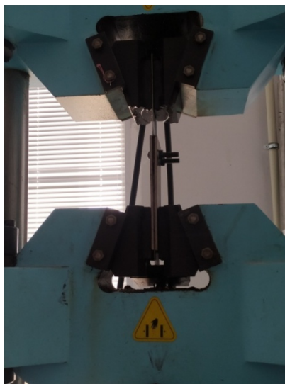
Рис. 4. Общий вид испытания образцов нахлесточных соединений
