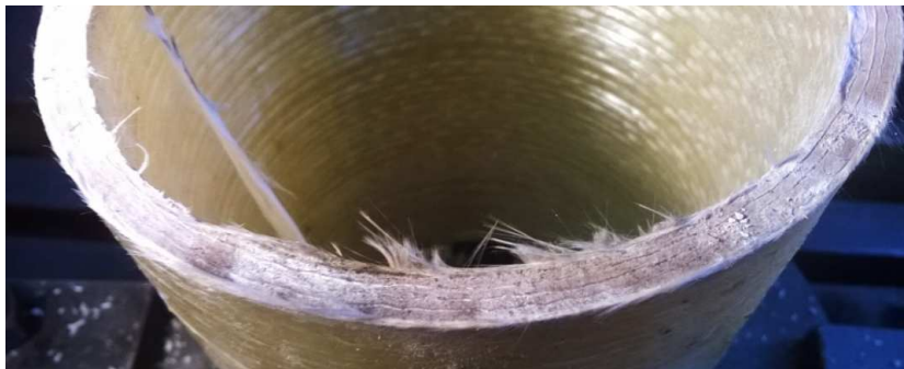
Рис. 1. Расслоение, прижоги обработанной поверхности
