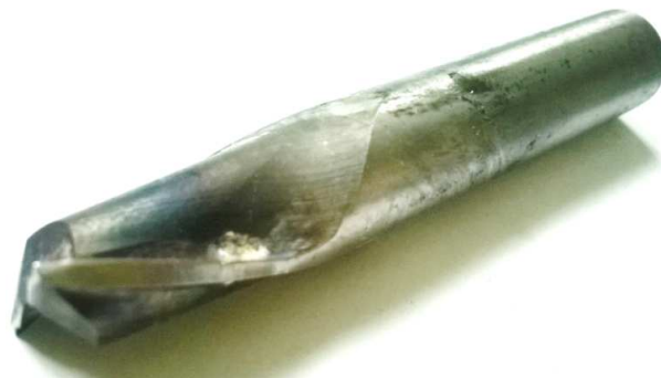
Рис. 2. Двухзубая концевая фреза (инструментальный материал - P6M5) после работы при температуре свыше 300°С
