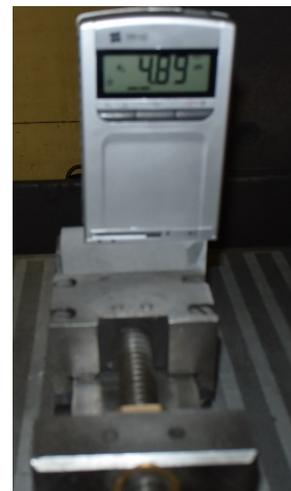
Рис. 2. Измерение шероховатости металлополимерного образца профилометром TR110
