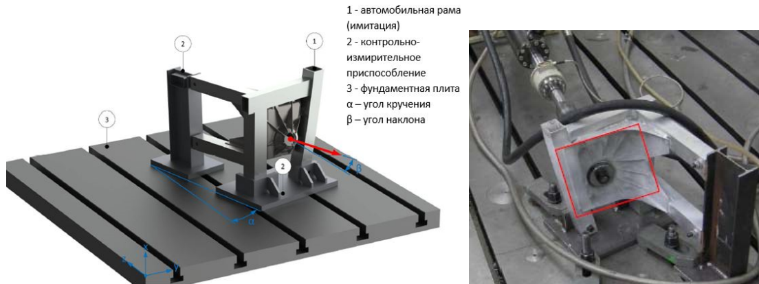
Рис. 5. Испытательный стенд: 1 – автомобильная рама (имитация); 2 – контрольно-измерительное приспособление; 3 – фундаментная плита; \alpha – угол кручения; \beta – угол наклона
