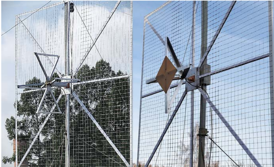
Рис. 2. Антенные элементы «бабочка» (слева) и «дельта» (справа) на испытательном стенде
