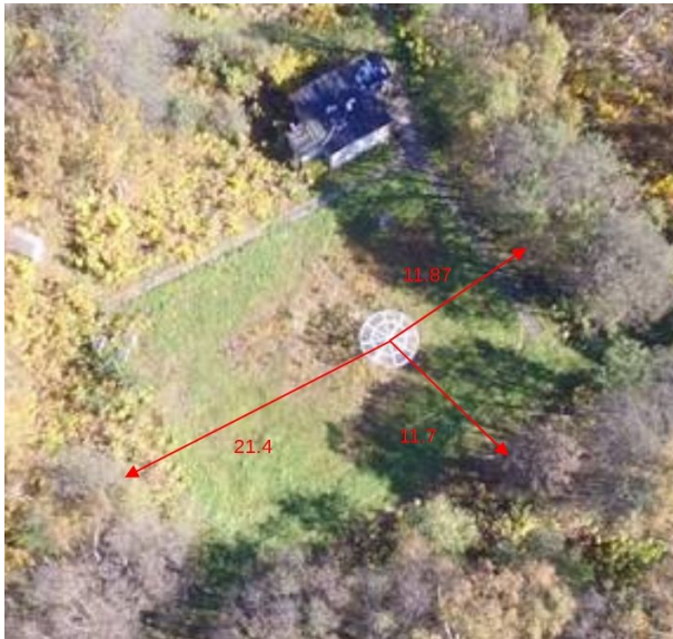
Рис. 4. Вышка, используемая при измерении напряженности приземного электрического поля в Паратунке, фото сделано с квадрокоптера, размеры в метрах
