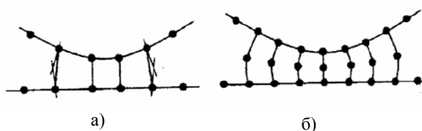
Рис. 2. Стержневые контактные конечные элементы: а – первого порядка; б – второго порядка элемент с нулевой высотой и нелинейной
