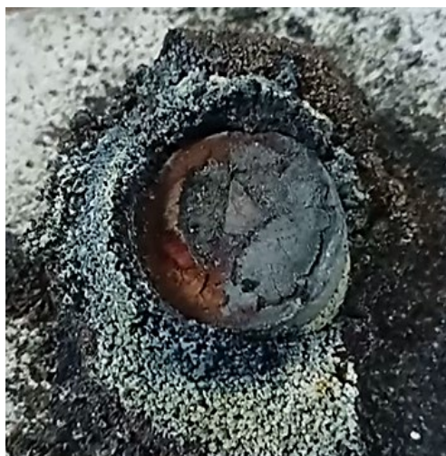
Рис. 6. Внешний вид центрального брикета после горения на воздухе
