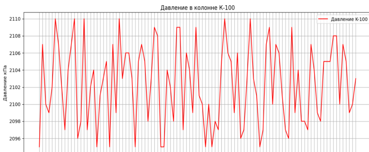
Рис. 5. График давления в диэтанайзере на период с 01.01.2020 по 01.08.2024
