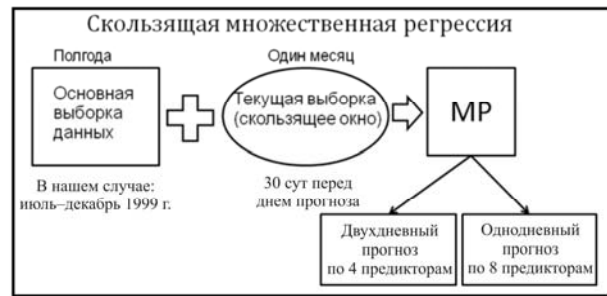
Рис. 5. Блок-схема алгоритма множественной регрессии со скользящим окном [Потапов и др., 2016]
