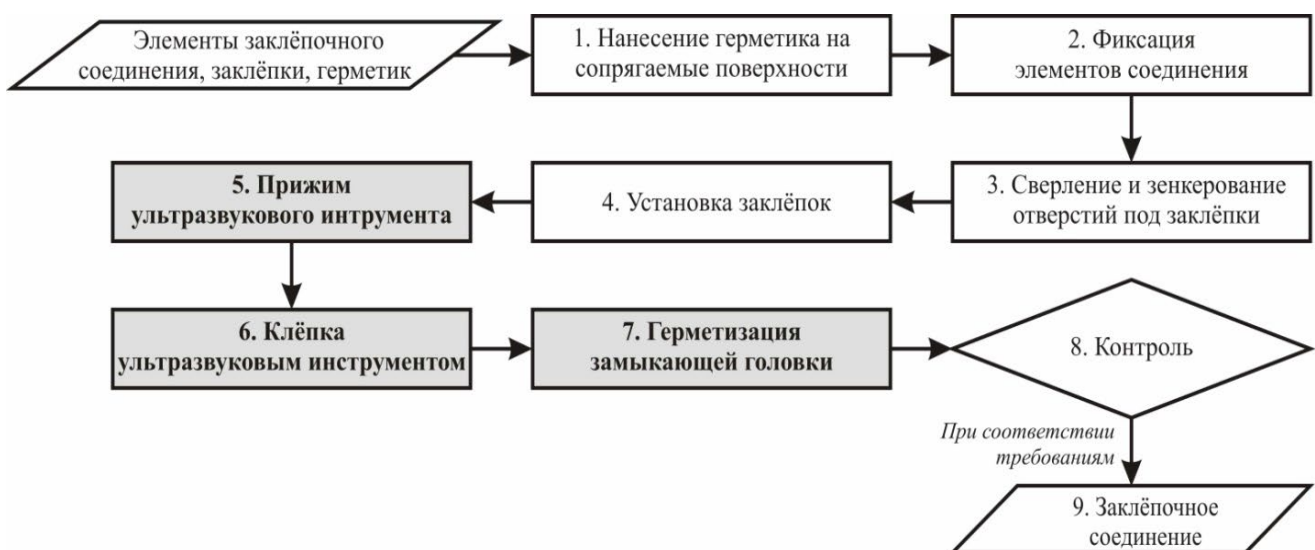
Рис. 2. Схема технологического процесса клёпки с использованием ультразвуковых колебаний
