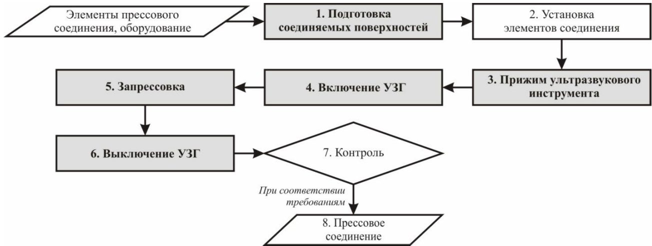
Рис. 4. Схема технологического процесса запрессовки с использованием ультразвуковых колебаний
