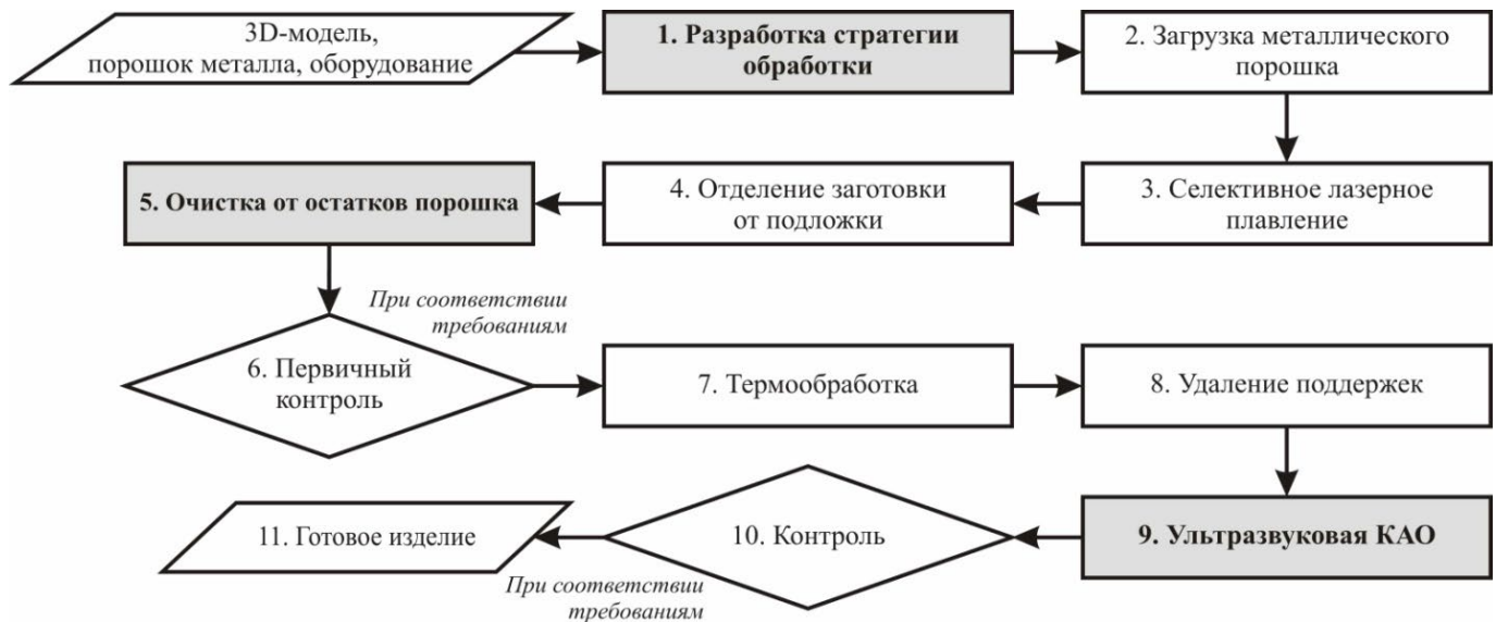
Рис. 5. Схема технологического процесса селективного лазерного плавления с использованием ультразвуковых колебаний
