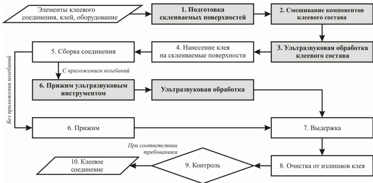
Рис. 3. Схема технологического процесса склеивания с использованием ультразвуковых колебаний
