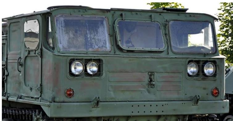
Рисунок 3 – Кабина с положительным наклоном лобового стекла
