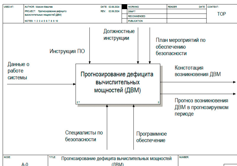
Рис. 1. Модель процесса прогнозирования дефицита вычислительных мощностей для значимого объекта критической информационной инфраструктуры в нотации IDEF0
