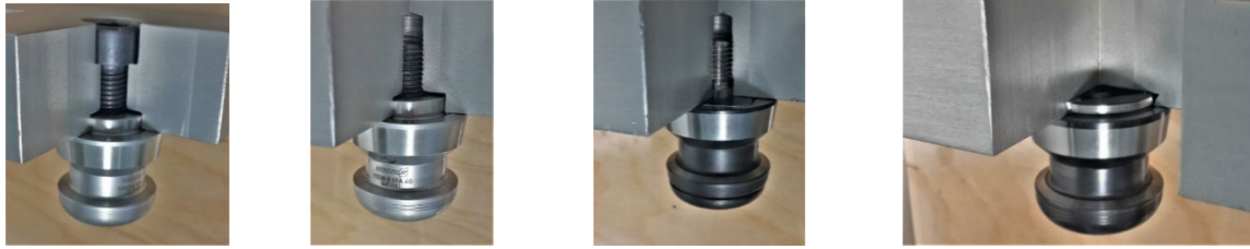
Рис. 1. Способы крепления базирующих пальцев системы
