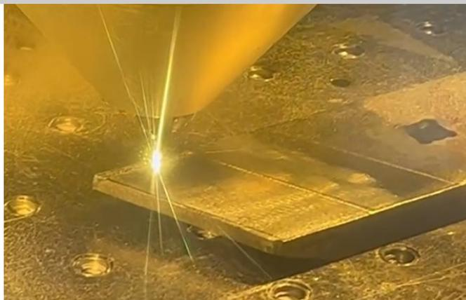
Рис. 1 – Процесс нанесения упрочняющего материала на экспериментальный образец долота
