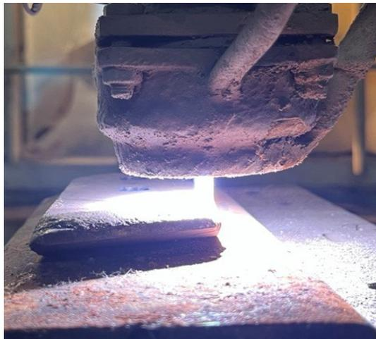
Рис. 3 – Установка плазменно-порошковой наплавки в среде сжатого воздуха
