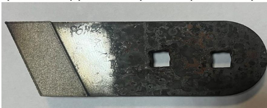
Рис. 2 – Образец долота, упрочненный методом селективного лазерного спекания
