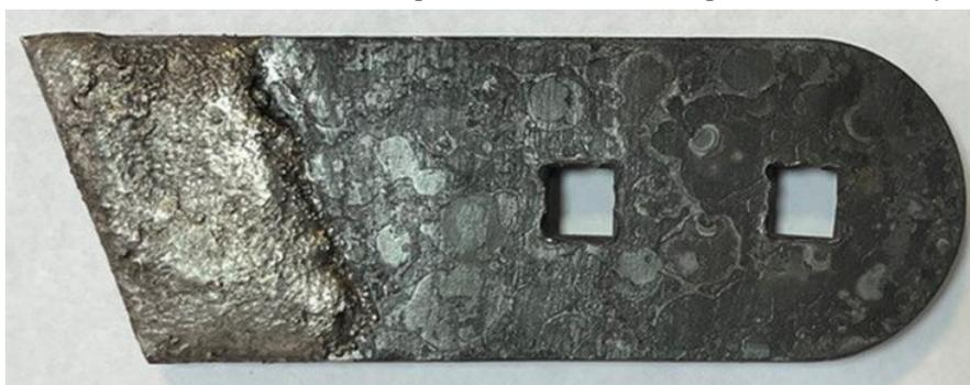
Рис. 4 – Образец долота, упрочненный плазменно-порошковой наплавкой в среде сжатого воздуха
