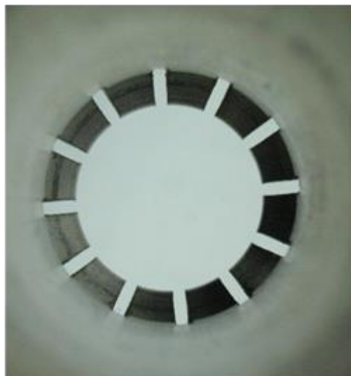
Рисунок 1 – Проточные каналы в торце форсунки
