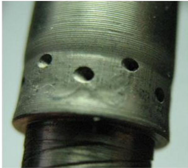
Рисунок 2 – Высоконапорная форсунка с тангенциальными отверстиями
