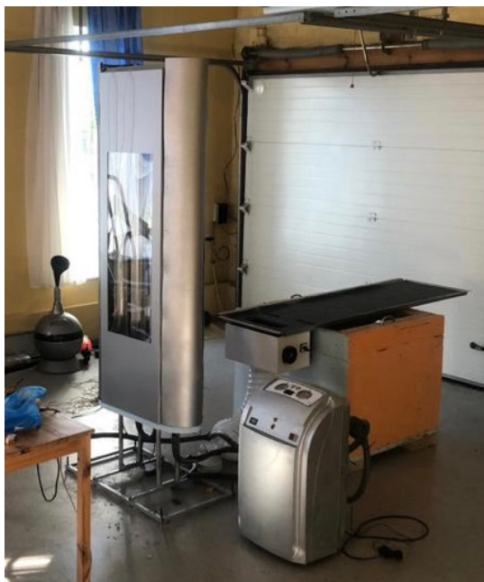
Рис. 1. Экспериментальный стенд с воздушным тепловым насосом, оснащенный системой MOVEBIT
