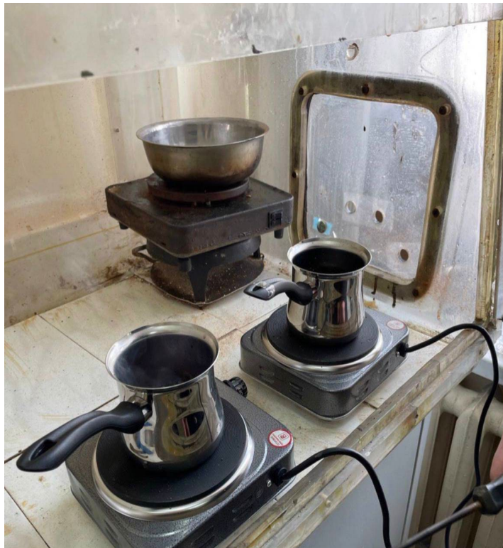
Рис. 1. Общий вид установки для проведения растворного СВС
