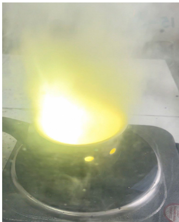
Рис. 2. Высокоэкзотермическая реакция в образце во время растворного СВС
