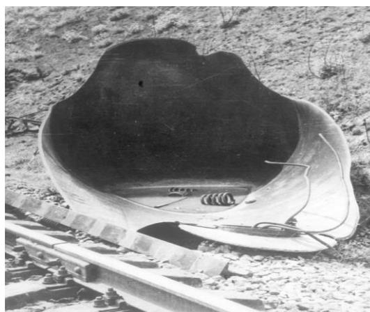
Рис. 1. Последствия нахождения котла цистерны в очаге пожара
