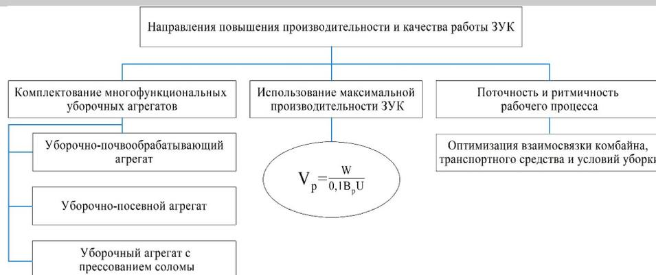
Рис. 2 – Новые направления повышения эффективности работы зерноуборочных комбайнов
