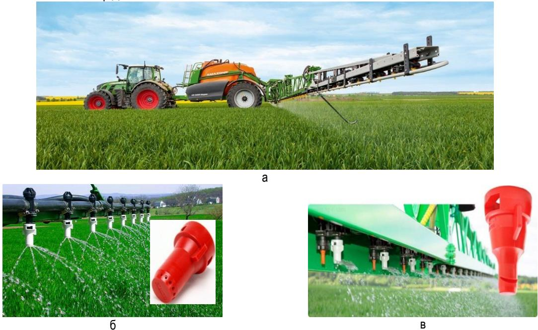
Рис. 2. Опрыскиватель (а) с дефлекторными (б) и струйными (в) форсунками
