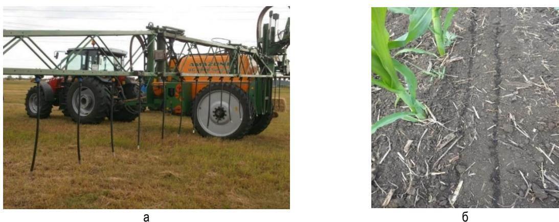
Рис. 3. Подкормка опрыскивателем с удлинительными штангами (а),
