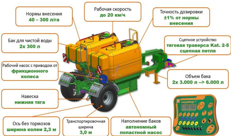
Рис. 7. Агрегат FDC 6000 для оборудования технологических комплексов – сеялок различного типа и назначения компании «AMAZONEN-Werke» для одновременного внесения жидких минеральных удобрений при посеве
