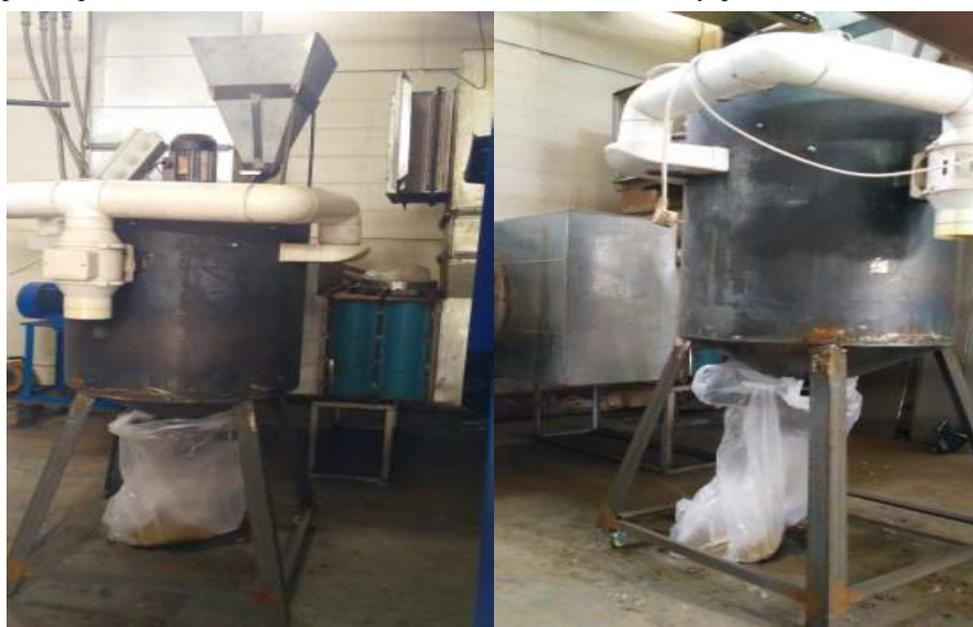
Рис. 11 – Запатентованный экспериментальный скарификатор семян
