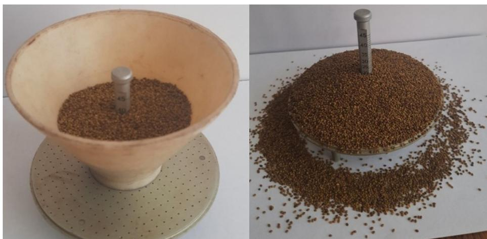
Рис. 5 – Процесс определения угла естественного откоса
