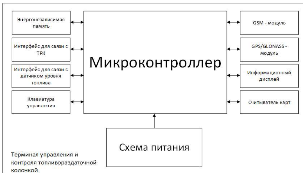
Рис. 2. Структура терминала Fig. 2. Terminal structure
