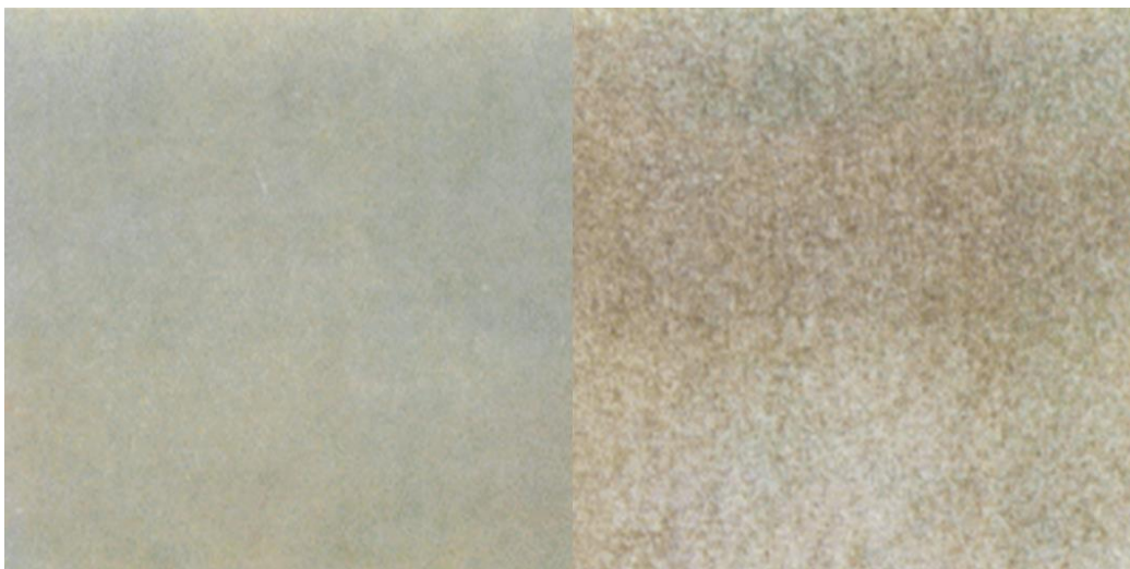
Рис. 1. Фотография металлической поверхности после обработки газодинамическим методом (слева) и с использованием типовой технологии (справа)
