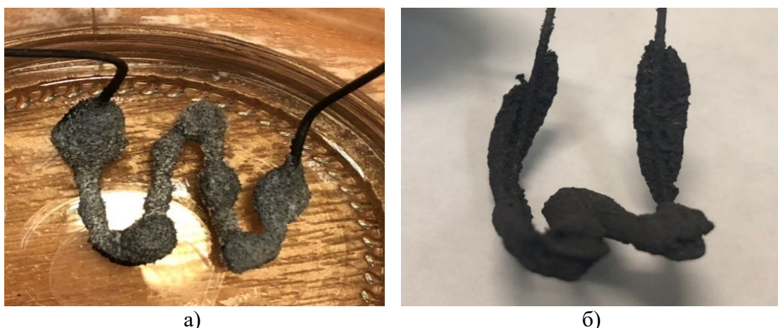
Рис. 3. Вольфрамовая спираль из несгоревшего образца, с образовавшимся на них продуктом высокотемпературного взаимодействия компонентов шихты: а) \langle \text{SiO}_2 + \text{NaN}_3 \rangle ; б) \langle \text{SiO}_2 + \text{NaN}_3 + \text{Si} \rangle
