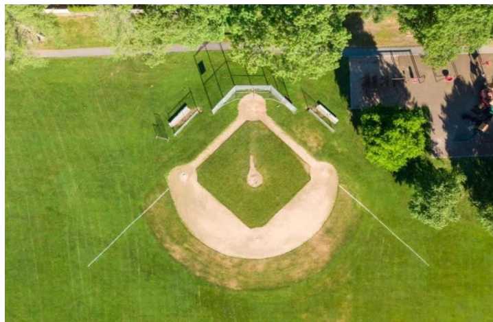
Рис. 2 - Общий вид полигона, используемого для калибровки камеры (высота – 78 м)
