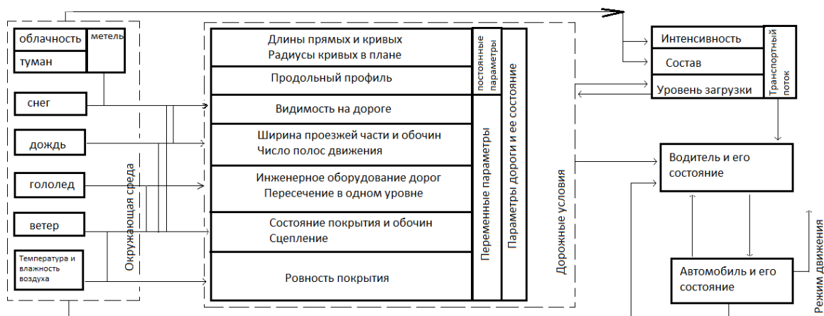
Рис. 1. Схема взаимодействия систем и факторов комплекса «водитель-автомобиль-дорога-среда»
