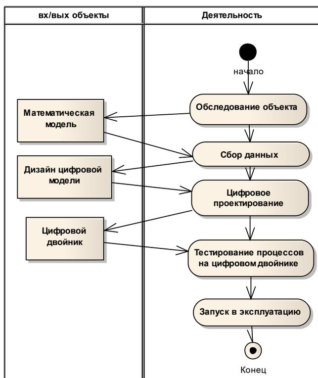
Рис. 2. Процесс создания и использования цифрового двойника.
