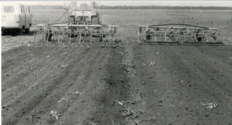
Рис. 1 – Качество работы двух культиваторов на Поволжской МИС: слева – КПС-4+4-БЗТС-1, справа – КПС-4К
