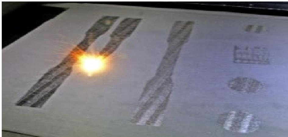
**Рис. 5.** Процесс послойного лазерного сплавления
