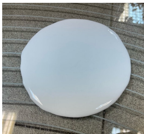
Рис. 6. Испытание литьевых смесей на растекаемость
